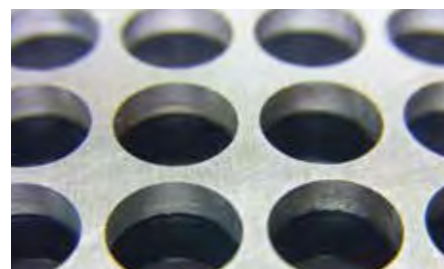
アルミ裏面（CFRTP+アルミ同時穿孔） S=2660\text{rpm} F=37\text{mm}
