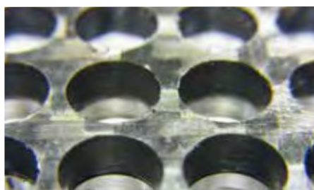
CFRTP裏面（アルミ+CFRTP同時穿孔） S=2660\text{rpm} F=37\text{mm}
