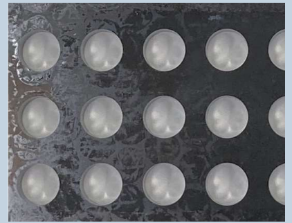
工具径の \phi dx125\% \sim \text{MAX}2 倍まで可能
